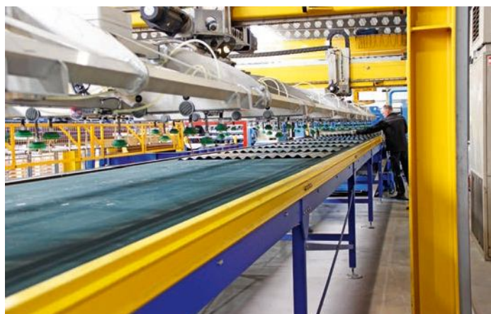
De op maat gemaakte gevelplaten worden zorgvuldig gecheckt nadat ze gewalst zijn.
